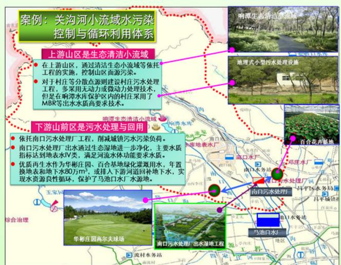
图4 以小流域为单元的水污染控制与循环利用技术体系
