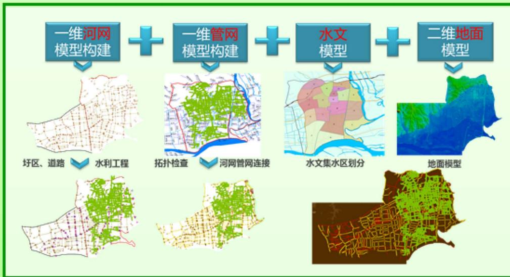
河网-管网耦合的水文-水动力模型
