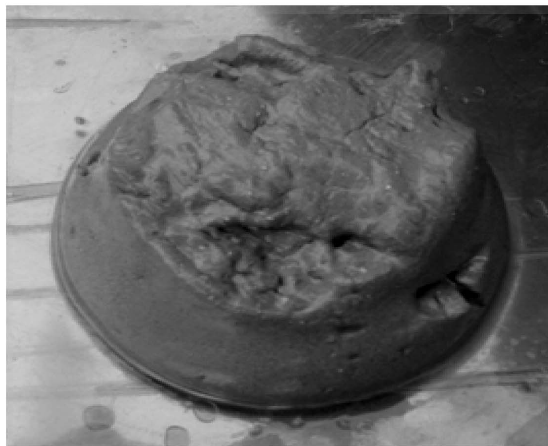
图 3.2 在 0.5m/s 水流冲蚀 60s 后的形状
